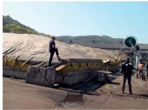
Abb. 9: BIODEGMA®-Rottebox (Quelle B&P)
